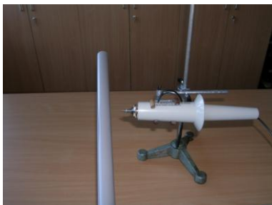
Obr. 3 Sršení náboje z nabitě novodurové tyče do hrotu sondy
