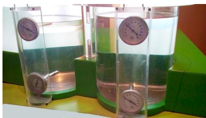
Obr. 4 Teploměry ukazují rozdílné teploty v nádobě se solnými roztoky
