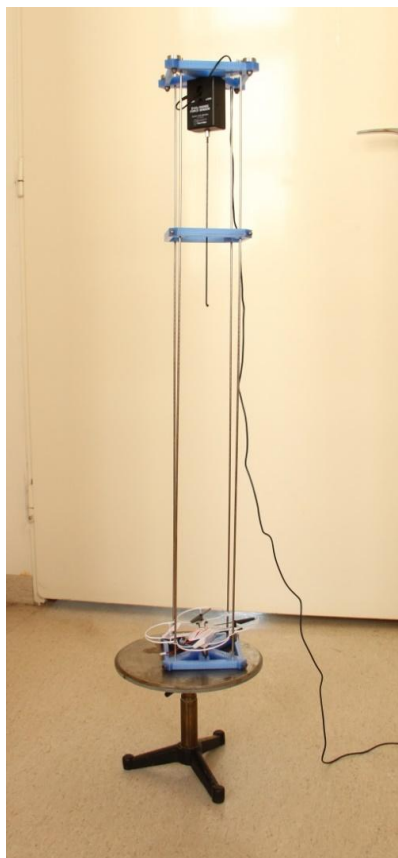
Obr. 7: Dron ve vodičí kleci pro měření
