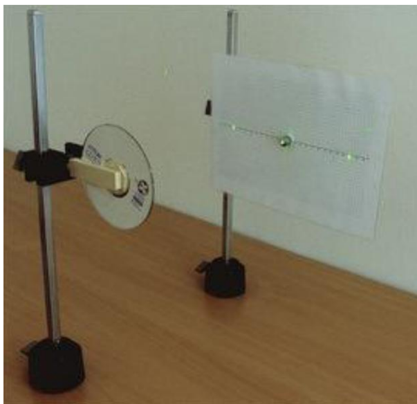
Obr. 3 Uspořádání experimentu s laserem vystupujícím ze středu čtvrtky
