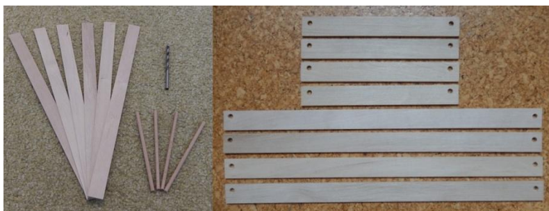
Obr. 3 Vlevo materiál na překotný hranol, vpravo po řezu a vrtání (ještě excentricky)
