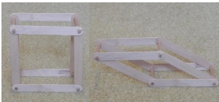
Obr. 2 Nepřekotný hranol sestavený z ústních lžiček (bez zpevnění okrajů lepidlem)
