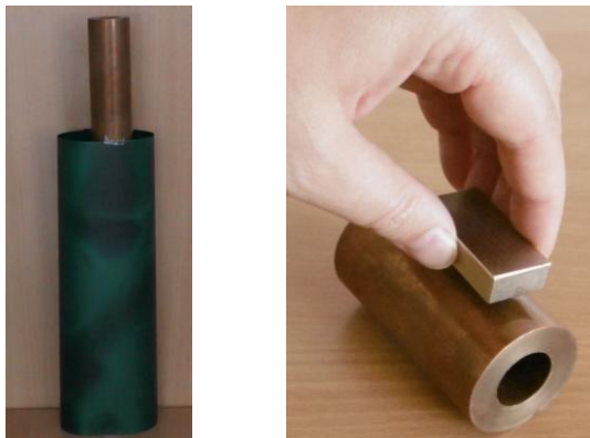
Obr. 1a) Dlouhá trubka s magnetickou detekční folií, v horní třetině folie je vidět pozice padajícího magnetu. b) Kutálení krátké trubky pomocí magnetu
