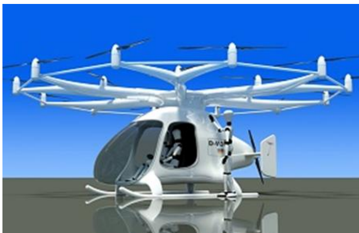
Obr. 5 Volokoptéra VC200 projektu e-Volo je první dvoumístná volokoptéra na světě
