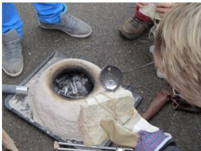
Obr. 4 Roztavený cín a jeho nalévání do kamenné formy
