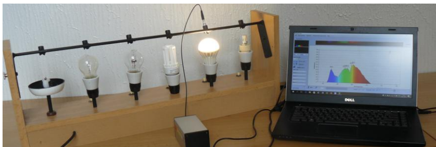
Obr. 4 Měření spekter světelných zdrojů
