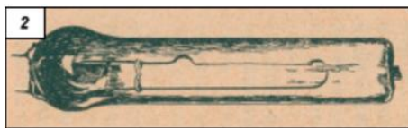
Obr. 1 Göbelovo uhlíkové vlákno zatavené do flakonu od parfému
